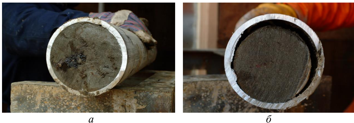
Рис.1. Расположение керна относительно керноприемной трубы при видимом разуплотнении пород (а) и без разуплотнения (б)
