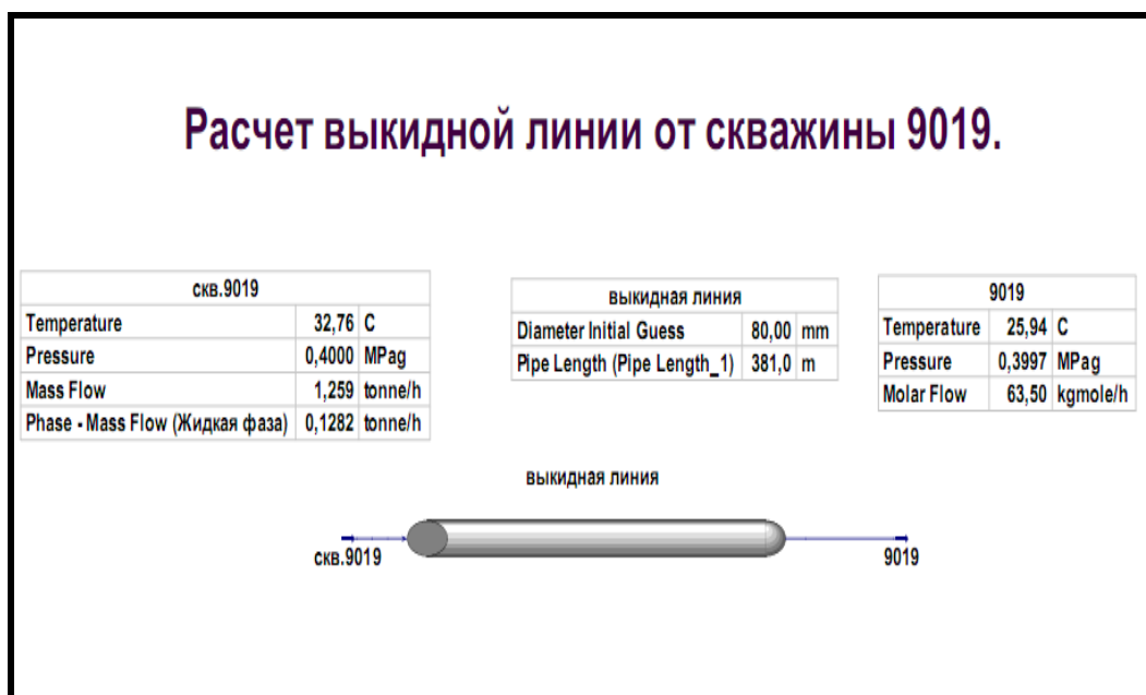
Рис.3. Модель расчета выкидной линии от скважины 9019, выполненная в программе HYSYS
